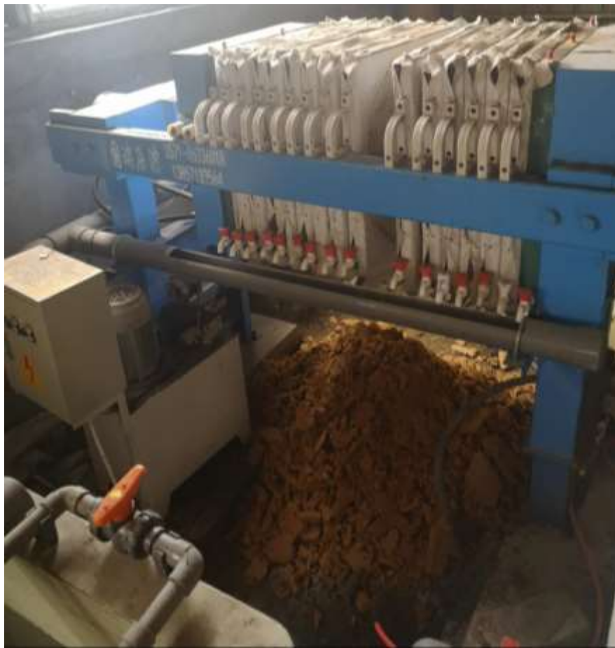
污泥压滤装置
